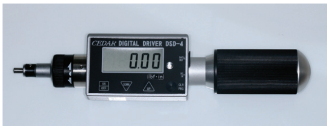
รูปที่ 3 เครื่องวัดแรงบิดแบบดิจิทัลที่ใช้ประเมินแรงบิดสูงสุดขณะปัก
