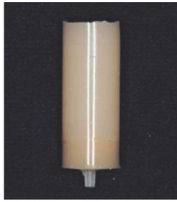
รูปที่ 2 ชิ้นงานตัวอย่างที่ทำการสร้างเรซินคอมโพสิตรอบไฟเบอร์โพลีเอสเตอร์ Fig. 2 A resin composite cylindrical specimen with a fiber post in the middle
