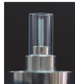
รูปที่ 1 แท่นยึดไฟเบอร์โพลีเมอร์และโครงล้อมรอบโพลีเมอร์สำหรับสร้างชิ้นงาน
