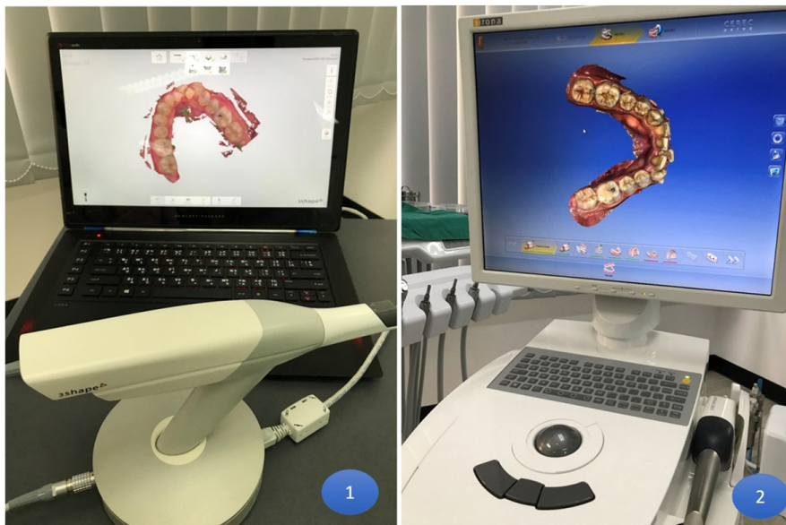
รูปที่ 2 เครื่องสแกนเนอร์ในช่องปาก 1) TRIOS® 2) CEREC Ortho® Figure 2 Intraoral scanners 1) TRIOS® 2) CEREC Ortho®
