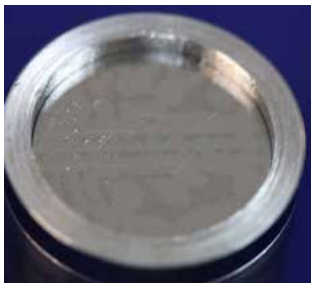
รูปที่ 1 การพิมพ์ในสถานะชื้นซึ่งมีคราบน้ำและละอองน้ำขนาดเล็กมากบริเวณพื้นผิวแม่แบบ Figure 1 Moist impression with water stain and spray on mold's surface
