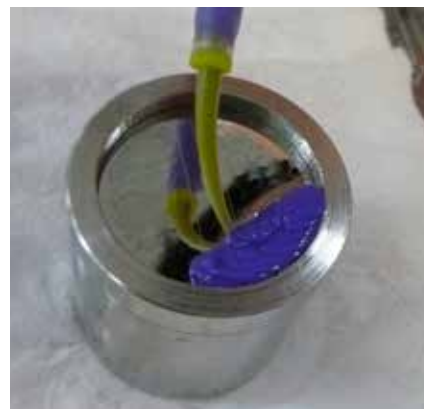
รูปที่ 1 การพิมพ์ในสถานะชื้นซึ่งมีคราบน้ำและละอองน้ำขนาดเล็กมากบริเวณพื้นผิวแม่แบบ Figure 1 Moist impression with water stain and spray on mold's surface
