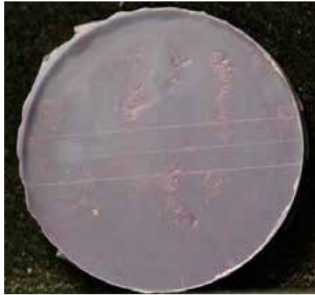
รูปที่ 3 รอยพิมพ์ที่มีตำหนิ เช่น ผิวไม่เรียบ มีหลุม ฟองอากาศ หรือคราบน้ำที่ทำให้ขาดความชัดเจนของเส้น Figure 3 Impression defects affecting line clarity, i.e. rough surface, void or water stain
